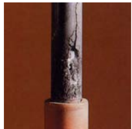
Нетрекинговостойкий материал (трубка черного цвета) разрушается уже после 48 часов испытаний
