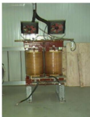
*Испытания Токами КЗ, до 42 кА/2сек*
