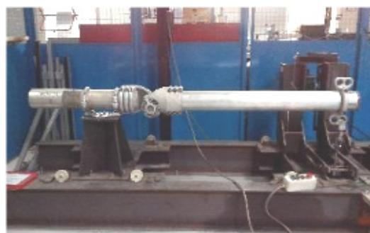
*Испытания на изгиб, до 5т/ось*
