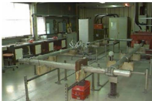
*Испытания на нагрев, до 10 кА*
