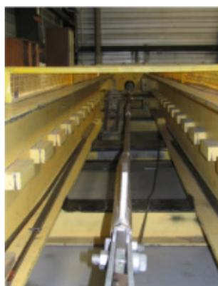
*Испытания на механическую прочность, до 70 т*
